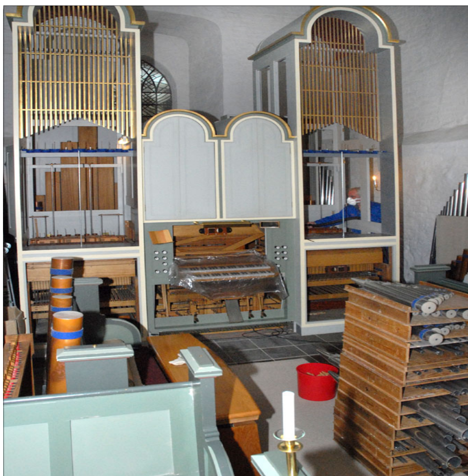
Hver af de 874 orgelpiber har sin helt egen plads i orgelet, så der skal holdes nøje styr på placeringen under rengøringsarbejdet.
